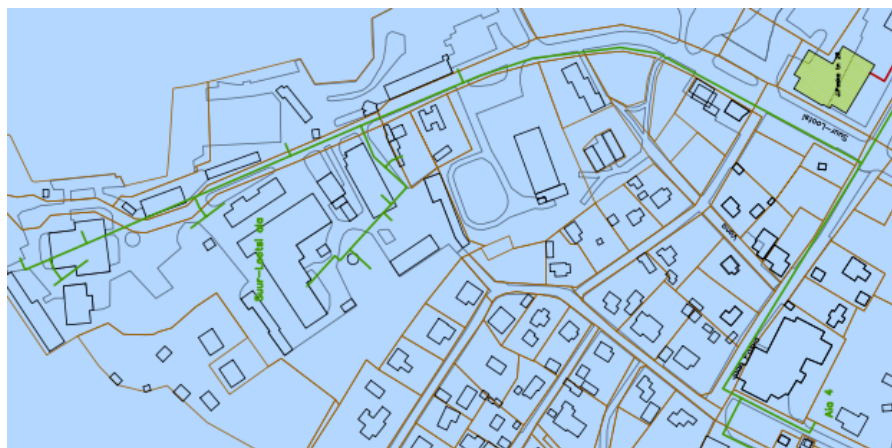
Joonis 4.11 Torustikud Suur-Lootsi arenduspiirkonna potentsiaalsete kaugküttetarbijate ühendamiseks (rohelised jooned)
